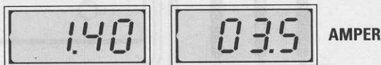
Fig.10 Se la corrente assorbita non supera i 2 amper, sul display vedrete apparire due decimali (vedi 1,40 amper), mentre se supera i 2 amper vedrete apparire un solo decimale (vedi 03,5 amper).
